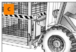
Infilare completamente le forche.
